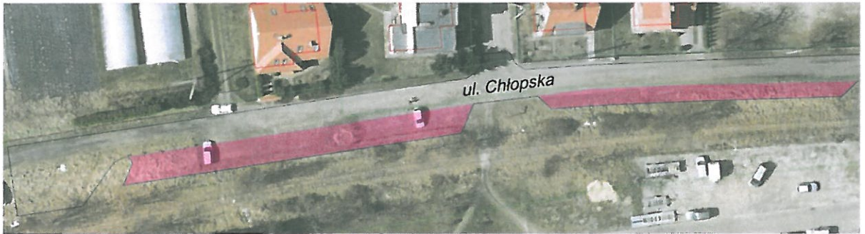
Zaprojektowane zatoki wzdłuż ul. Chłopskiej
